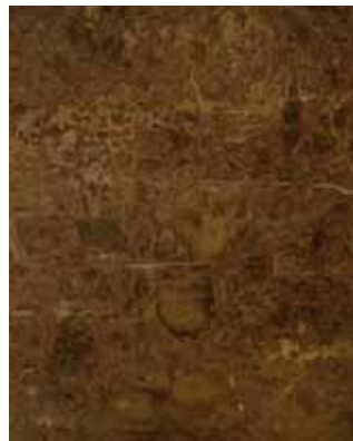
15. Bolechowice, górnodedewoński wapień brązowo-brunatny typu Chęciny-Góra Zamkowa/Bolechowice , próbka kamieniarska
