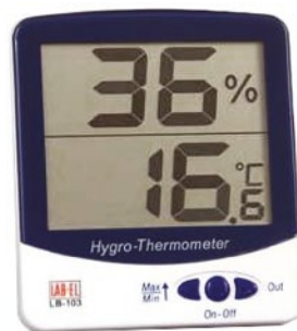
Fot. 29. Termohigrometr Przykładowy termohigrometr służący do rejestrowania temperatury i wilgotności w pomieszczeniu. Źródło: https://www.label.pl/po/ix.higrometry-domowe.html
