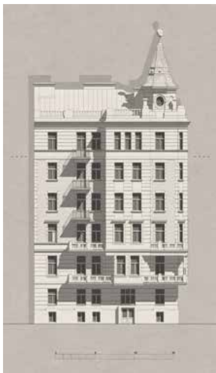
Kamienica przy ul. Smolnej 14 (1912), elewacja zachodnia z rekonstrukcją utraconej w 1944 r. ostatniej kondygnacji oraz partii zwieńczenia i dachów. Oprac. H. Przybyszewski (2024)
