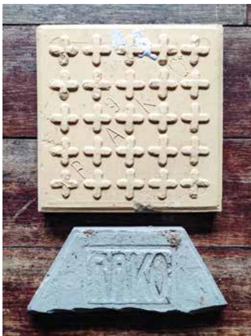
Rewersy płytek posadzkowych Rakonitzer Schamottewaren-, Mosaikplatten- und Ofenfabrik „RAKO” w Rakonitz (Rakovnik, ob. Republika Czeska)
